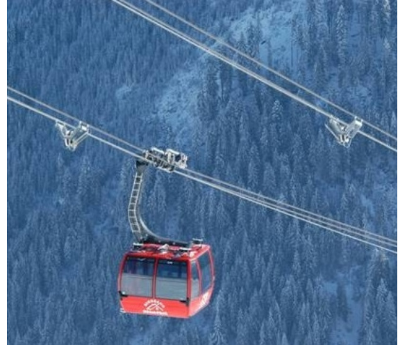
Abb. 18: Fotos: Seilreiter im Detail und Größenvergleich Seilreiter und Kabine (Quelle: Fa. Doppelmayr)
