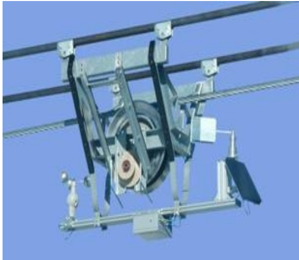
Abb. 18: Fotos: Seilreiter im Detail und Größenvergleich Seilreiter und Kabine (Quelle: Fa. Doppelmayr)
