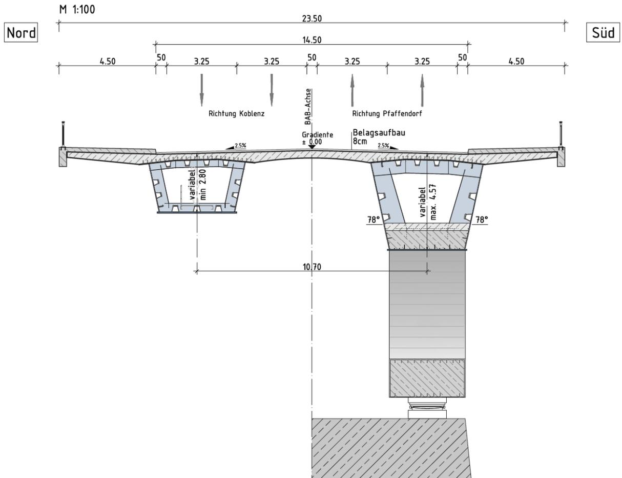
**Mit dem LBM abgestimmter Brückenquerschnitt**
