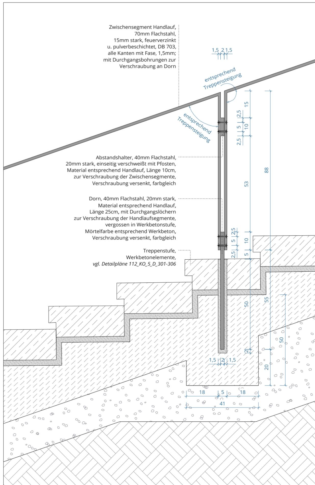
Verankerung Zwischensegment Treppengeländer - Schnitt längs
