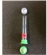
befestigt und im zeitlichen Intervall von 14 Tagen durch den Außendienst gewechselt. Im Labor wird dann die aufgenommene Menge an NO2 durch ionenchromatographische Analyse als Nitrit bestimmt. Aus der ermittelten Konzentration und der Probenahmedauer wird dann die Schadstoffkonzentration in µg/m³ berechnet.
