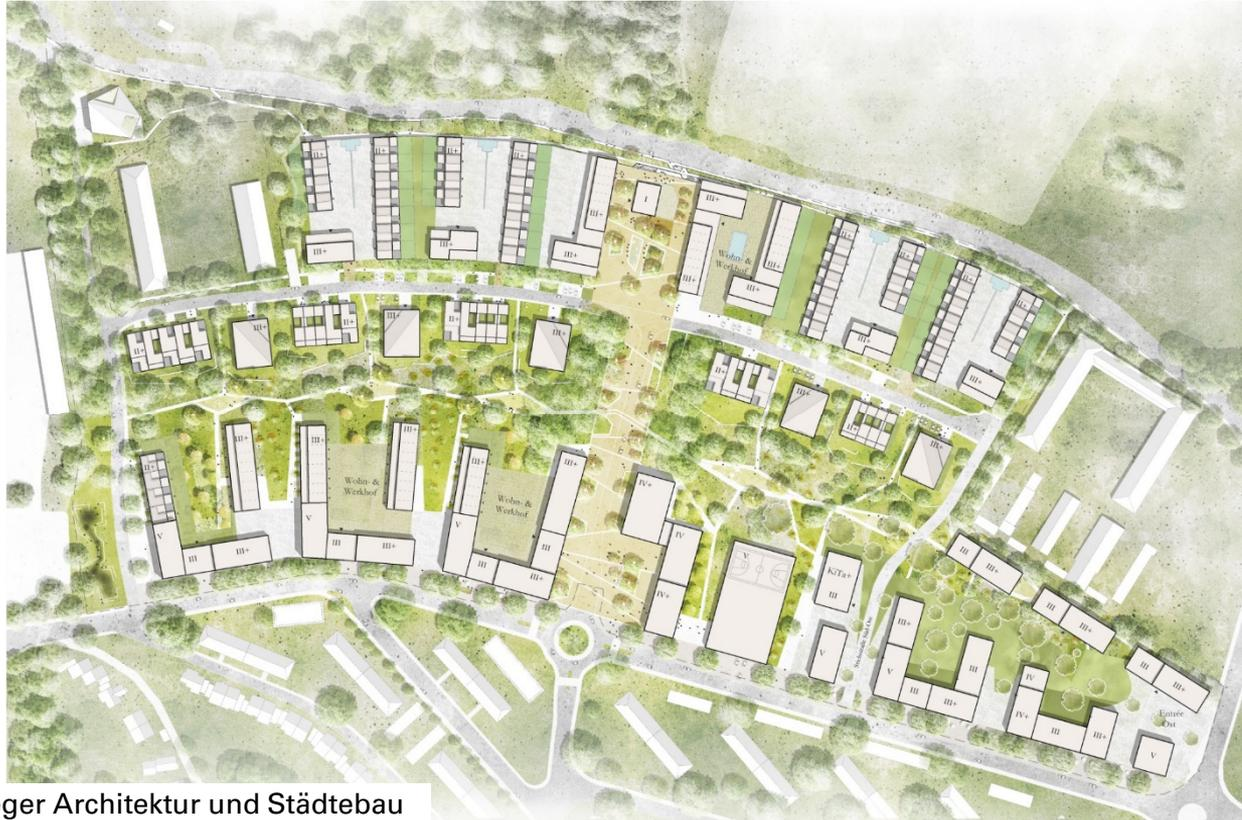
Der Lageplan enthält das Strukturkonzept mit der Erschließung und einer möglichen Bebauung. Im weiteren Planungsprozess sind Anpassungen der Gebäudekubaturen möglich.
