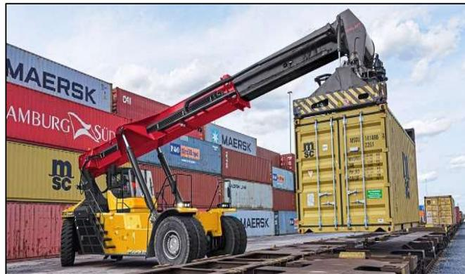
Abbildung 26: Containerumschlag mittels Reach Stacker (Quelle: [www.sanyeurope.com](http://www.sanyeurope.com) )
