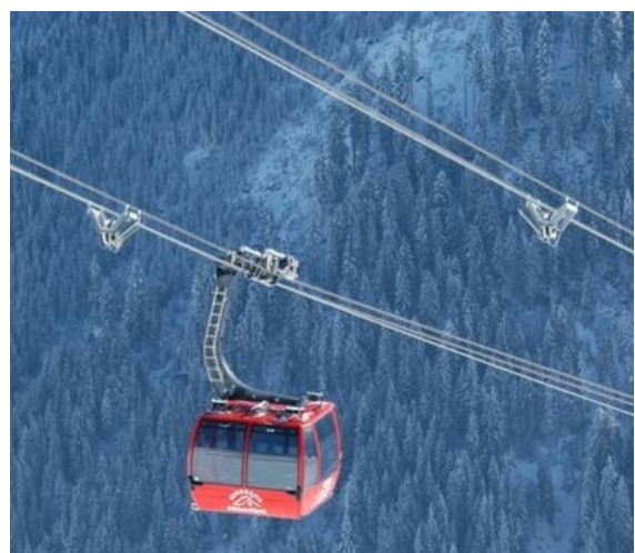
Abb. 9: Fotos: Seilreiter im Detail und Größenvergleich Seilreiter und Kabine (Quelle: Fa. Doppelmayr)
