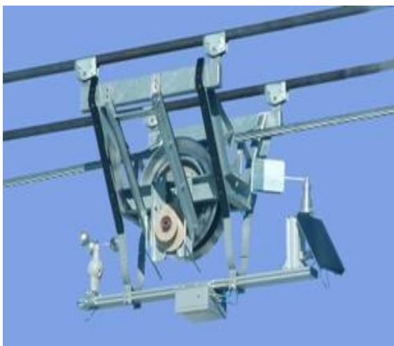
Abb. 9: Fotos: Seilreiter im Detail und Größenvergleich Seilreiter und Kabine (Quelle: Fa. Doppelmayr)
