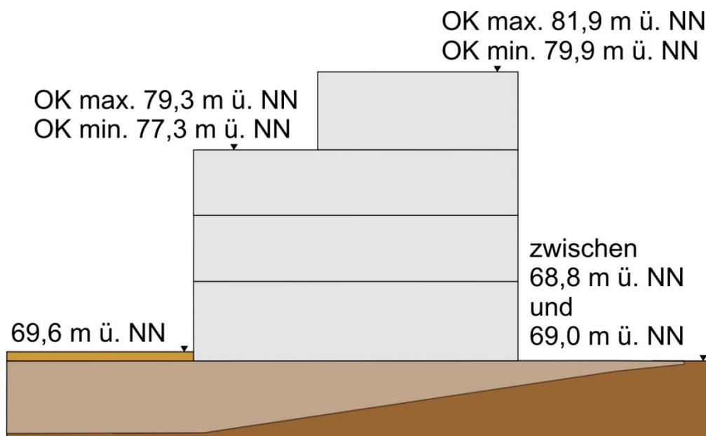
**Abbildung 4:** Systemschnitt zur ergänzenden Darstellung der maximalen Höhe baulicher Anlagen
