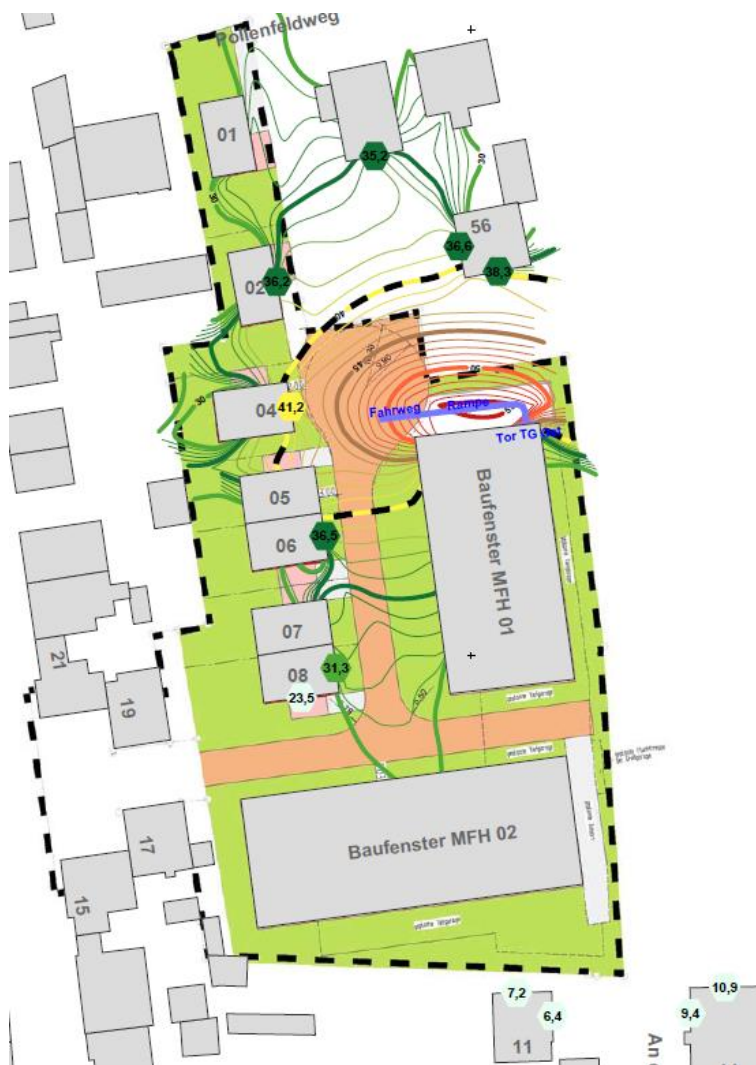
Abbildung 11: in Ansatz gebrachtes mögliches Bauungskonzept bei 1 Zu- und Abfahrt zu Tiefgarage 21 (unmaßstäblich)
