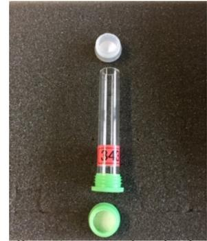
Der Vorteil der Passivsammler-Technik besteht darin, dass kein elektrischer Strom für den Betrieb notwendig ist. Außerdem können Messungen an Orten durchgeführt werden, an denen nicht genügend Platz für eine Messstation zur Verfügung steht.
