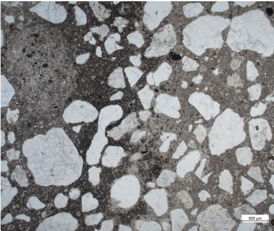
Abb. 1: Mörtel mit matrixgestütztem Gefüge. Das kalkhaltige Bindemittel ist auf der linken Bildhälfte dunkler, da nicht carbonatisiert, in der rechten Hälfte hingegen infolge der Carbonatisierung aufgehellt.
