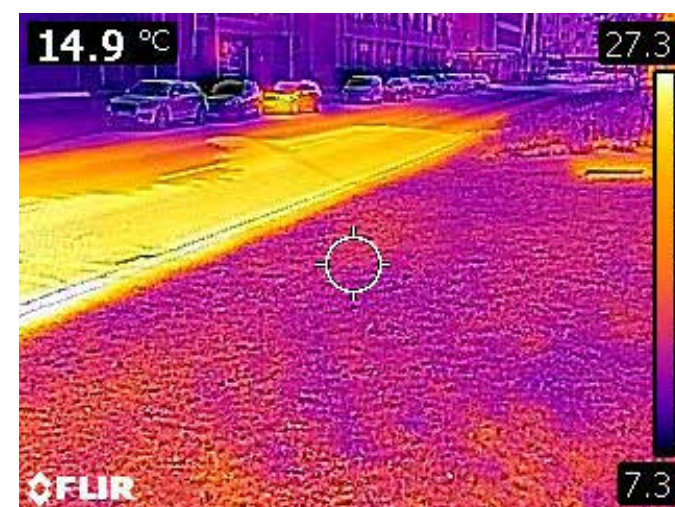
Abb. 10: Thermalmessung in der Innenstadt von Koblenz mit deutlichen Temperaturunterschieden zwischen Straßenasphalt und Grünfläche
