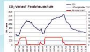
CO 2 -Messung in einem Klassenzimmer ruhender Lüftungsanlage in Abhängigkeit von der Anzahl der Menschen im Raum
