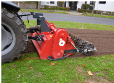
Maschinelle Saatbettvorbereitung mit Umkehrfräse
