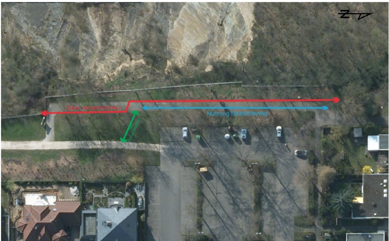
Abb. 1: Orthofoto mit Darstellung des neuen Wegeverlaufs: rot=neue Zauntrasse als Absturzsicherung, grün=neue Wegebeziehung, blau=Nutzung des Bestandswegs (Quelle: Stadtverwaltung Koblenz).
