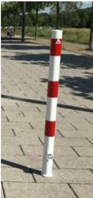
Absperrpfosten aus Stahl, Rundrohr Durchmesser 60 mm, Wandstärke ca. 2,0-2,5 mm, verzinkt, weiß beschichtet, mit drei reflektierenden Streifen aus Folie Typ RA 1
