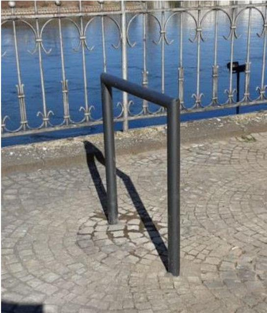
Fahrradanlehnbügel aus Stahl, bestehend aus zwei senkrechten Pfosten und einem horizontalen Holm, Ecken rechtwinklig auf Gehrung verschweißt; ortsfest zum Einbetonieren; Höhe über GOK 800 mm, Tiefe unter GOK ca. 400 mm, Breite 800 mm, aus Rundrohr Durchmesser 60 mm, Wandstärke ca. 2 mm, verzinkt und farbbeschichtet mit 2 K – Epoxydharzlack, **Farbton DB 703**
