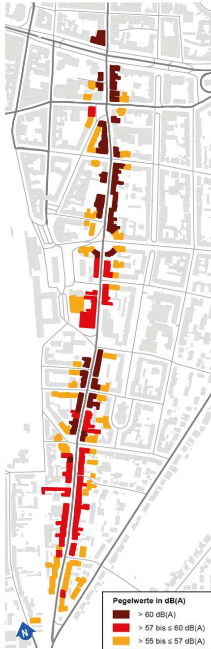
Lärmbelastung (L Night ) ohne Maßnahme
