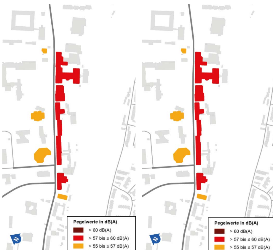
Lärmbelastung (L Night ) ohne Maßnahme
