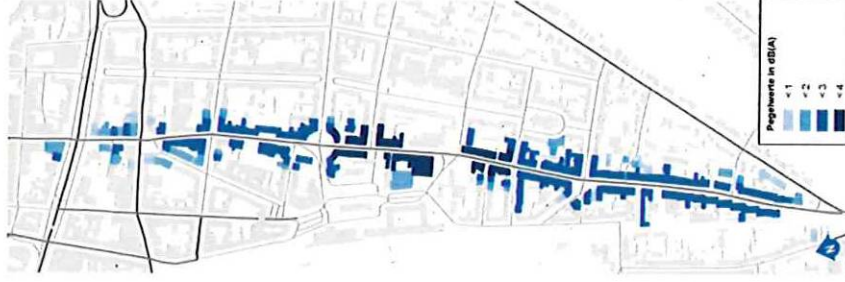
Abbildung 6: Hohenzollernstraße Pegeldifferenz (ohne Maßnahme – mit Maßnahme)
