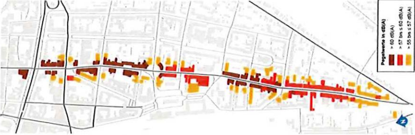
Lärmbelastung (L Night ) ohne Maßnahme
