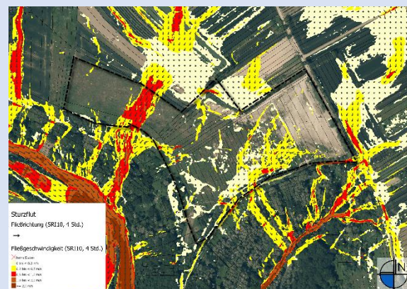
Abbildung 9: Auszug aus der Sturzflutgefahrenkarte mit Fließgeschwindigkeiten bei einem extremen Starkregenereignis (SRI 10) mit einer Regenmenge von ca. 112 – 136 mm in 4 Stunden und Lagedarstellung des Plangebietes (unmaßstäblich, Plangebiet = schwarz umrandet)
