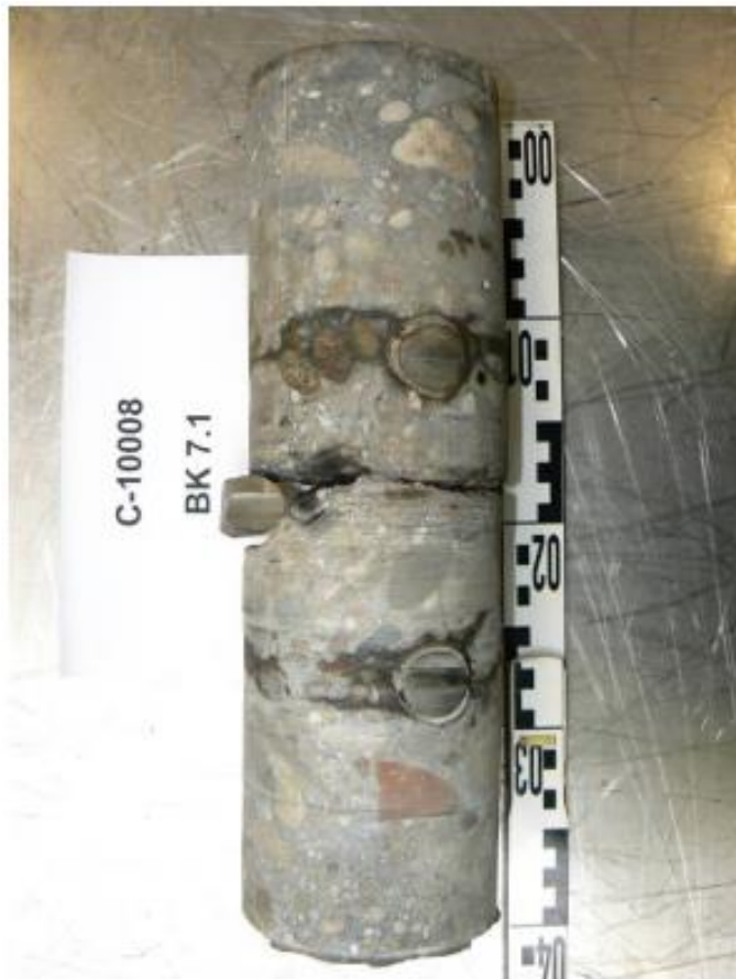
Abb. 5 Stegrisse nachgewiesen über Kernbohrungen Europabrücke stadteinwärts
