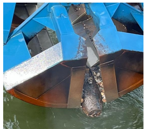
Bilder 3 und 4 Bombenfunde bei Nassbaggerarbeiten
