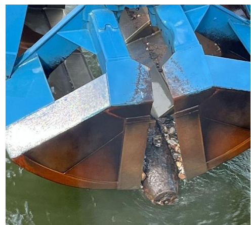
Bilder 3 und 4 Bombenfunde bei Nassbaggerarbeiten
