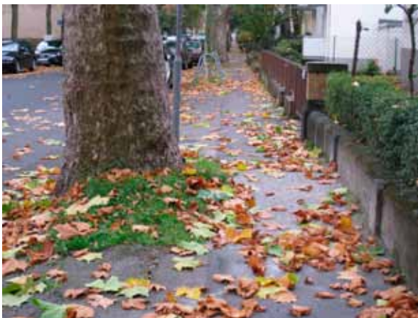
Baumstandort zu nah an der Grundstücksgrenze; eingengte Nebenanlagen
